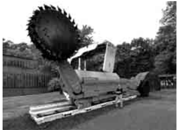
Landek: kombajn Panda francouzské firmy Sagem pro velmi mocné sloje (do 6 m). Sekce Ostroj MEOS 26/56, dopravník DBT PF4/1032. Možná zde studovat pojezdový systém Dynaride. Další menší podobné kombajny a sekce byly na Landeku sešrotovány. Foto: M. Přibíl, 2012
