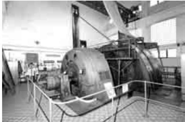
Důl Centrum, strojovna šachty C2. Těžní stroj, ČKD Praha typ B 40009-AR 2 3A, 1954 - kulturní památka. Foto: Martin Přibil, 2016
